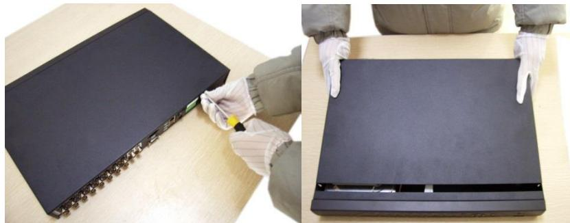
Открутите шурупы и снимите верхнюю крышку устройства
