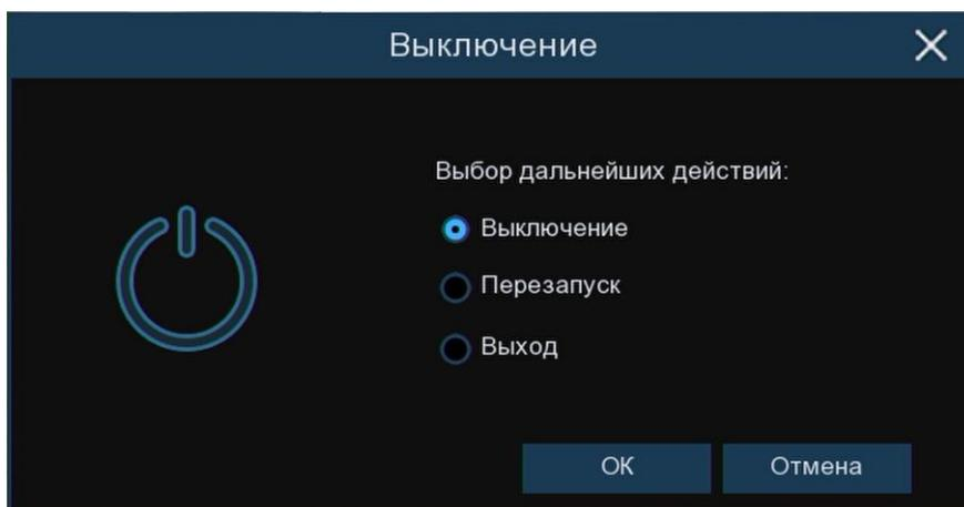
**Во время работы устройства нежелательно выключать его нажатием на кнопку на задней панели или прямым отсоединением кабеля блока питания от разъема питания, особенно в процессе записи!**
